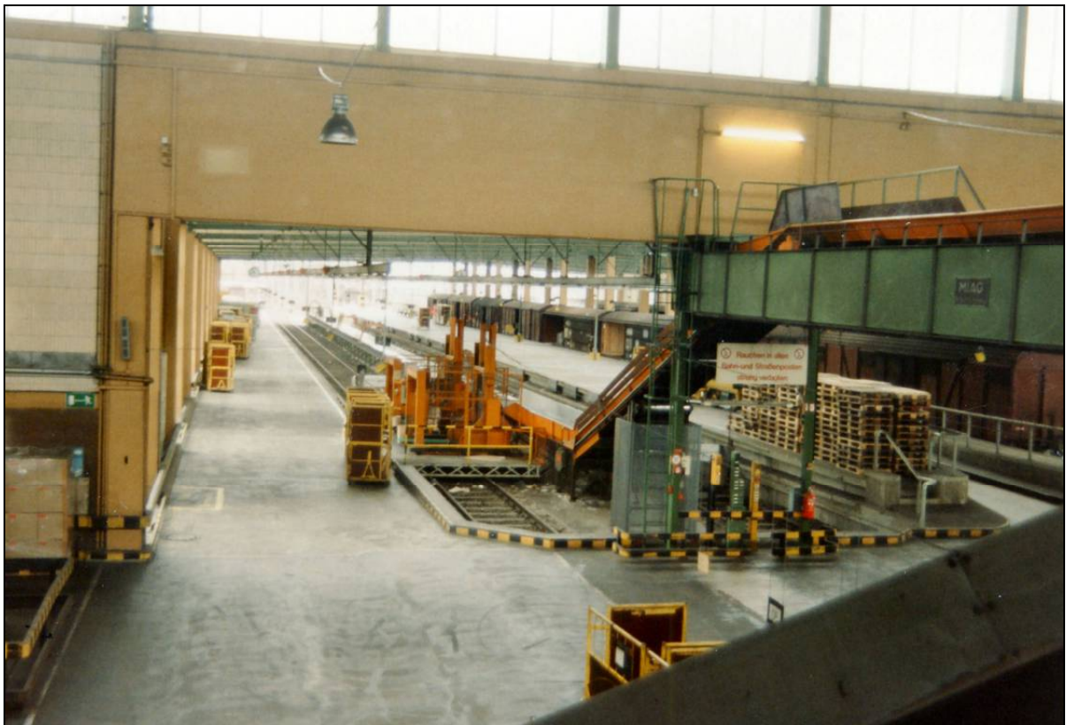
Bild 20: Entladegleis 306 mit später installierter Rollbehälter-Kippanlage, vom Pakum aus gesehen. Rechts Paket-Förderband mit Reparaturbühne, rechts unten: Paket-Förderband von Einlieferer und Selbstbucher – Kundenhof (Foto K. Tasche)
