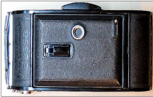
Bild 8: Stativ-Gewinde 3/8" im Deckel/Boden für vertikale Aufnahmen (Bilder)
