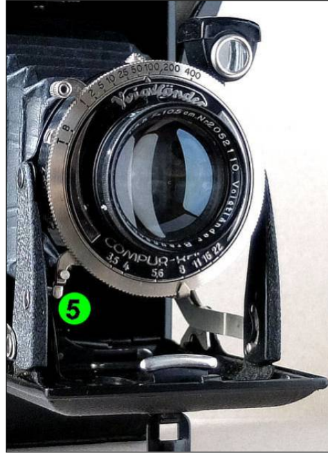
Bild 3 und 4: Links horizontale Draufsicht, rechts Standarte mit Objektiv und Verschluss
