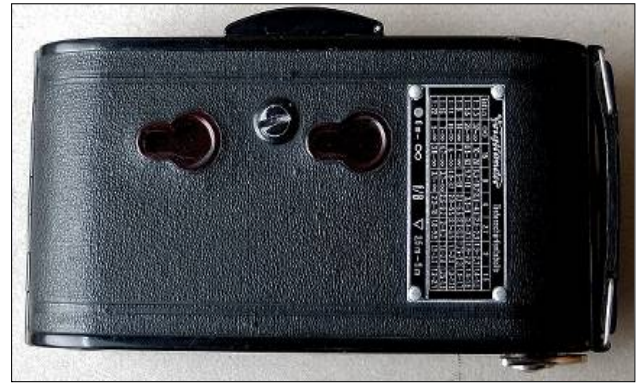
Bild 8: Stativ-Gewinde 3/8" im Deckel/Boden für vertikale Aufnahmen (Bilder)
