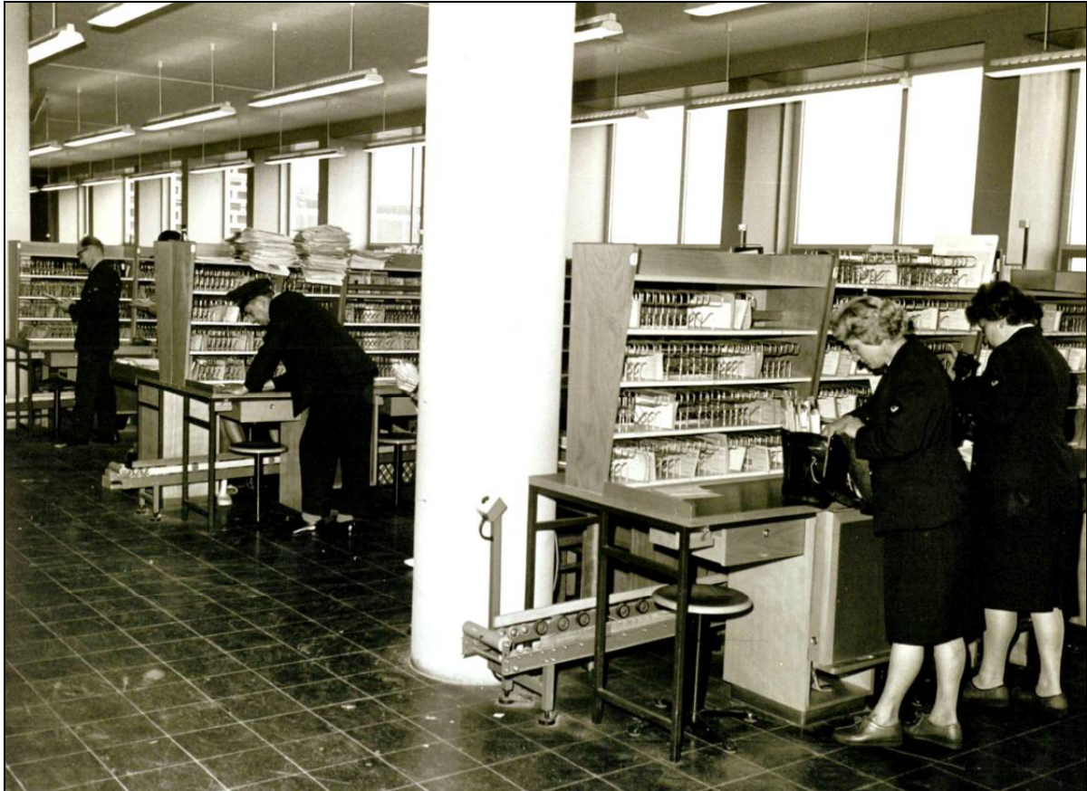
Bild 17: Briefzustellertische mit Verteilplätzen im 1. Obergeschoß. Hier sind die Schwerkraft-Stapelröllchenbahnen unterhalb der Verteilspinde gut zu erkennen.
