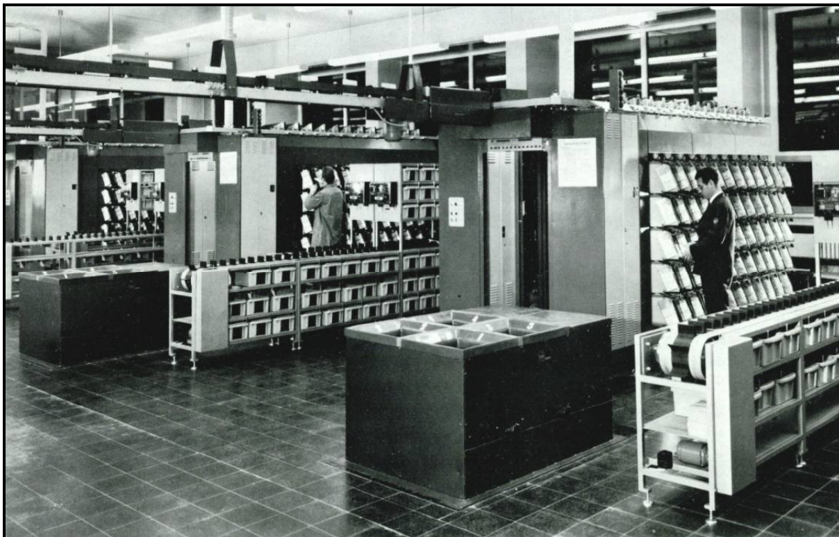
Bild 13: Verteilmaschinen, Behälterstapelregale mit Abschnittsförderer und Einwurfschächte Bundeanlage. Rechts zwischen FVM und Abschnittsförderer steht Herr H. Krause in Dienstkleidung. Diese Aufnahme entstand unmittelbar nach dem Aufbau der BVA und vor der Inbetriebnahme.
