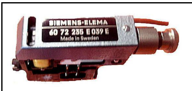
Bild 2 u. 3: Drehmagnetmeßwerk für Flüssigstrahl-Oszillographen im Oscillomink, Siemens-Elema. Oscillomink ist die Produktbezeichnung der Fa. Siemens.
