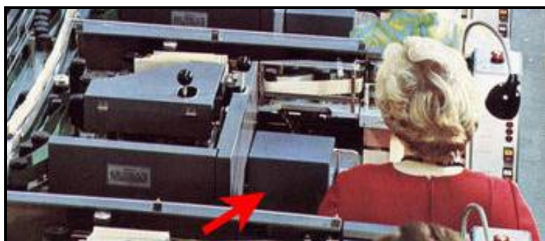
Bild 1: Codierplatz CP 770. Die Druckwerke befinden sich am Codierplatz zwischen Platzstapler und Tastatur, abgedeckt durch eine Haube (Ausschnittsbild aus AEG-Telefunken-Broschüre 3300 Braunschweig).
