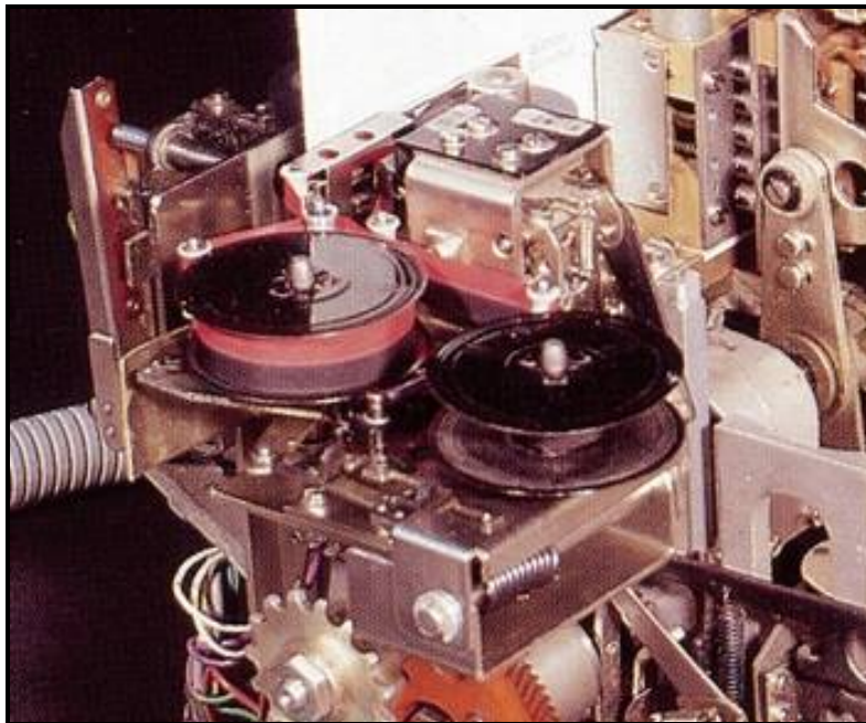
Bild 3: Das Farbbanddruckwerk am Foliendruckwerk befestigt. (Teilbild aus Technikgeschichte Siemens ElectroCom, Konstanz 1997)
