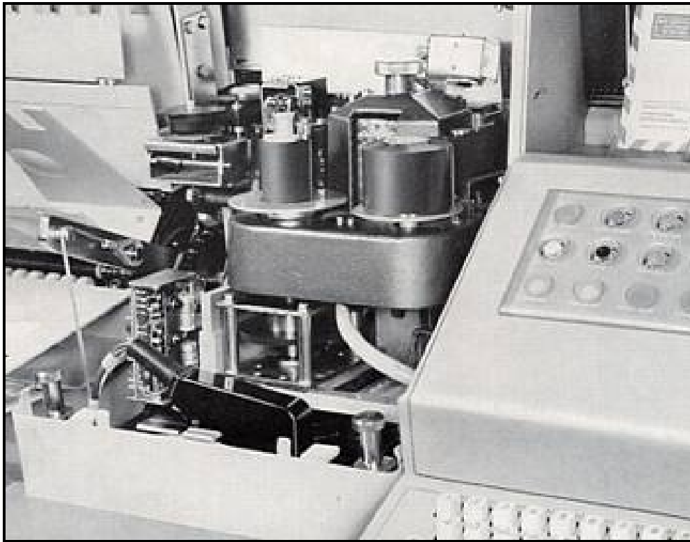
Bild 2: Druckwerk in der Briefverteilanlage Pforzheim. Hier mit einer Heißprägefolie mit magnetischer Beschichtung bestückt. (aus SIEMENS & HALSKE Vollautomatische Briefverteilanlage)
