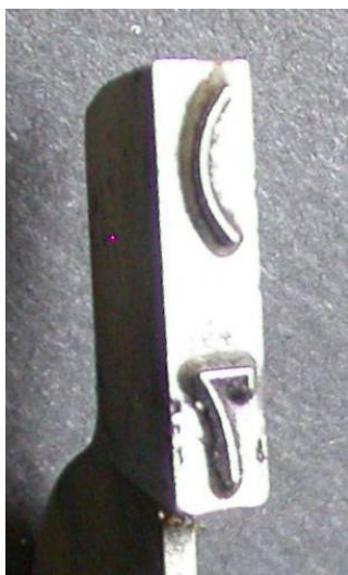
Bild 8: Stahltype mit Ziffer 7 und (-)-Zeichen.
