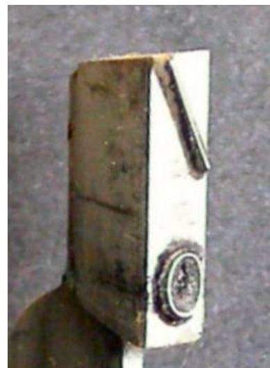
Bild 9: Stahltype mit Ziffer 0 und \-Zeichen.
