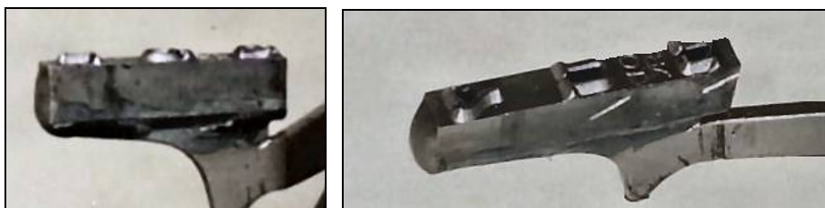
Bild 14 u. 15: Stahltypen von RaRo mit drei Zeichen
