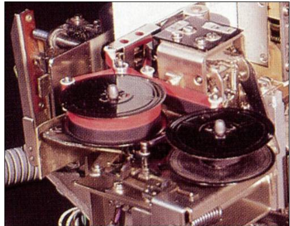
Bild 3: Farbbanddruckwerk (Teilbild aus Technikgeschichte Siemens ElectroCom, Konstanz 1997)
