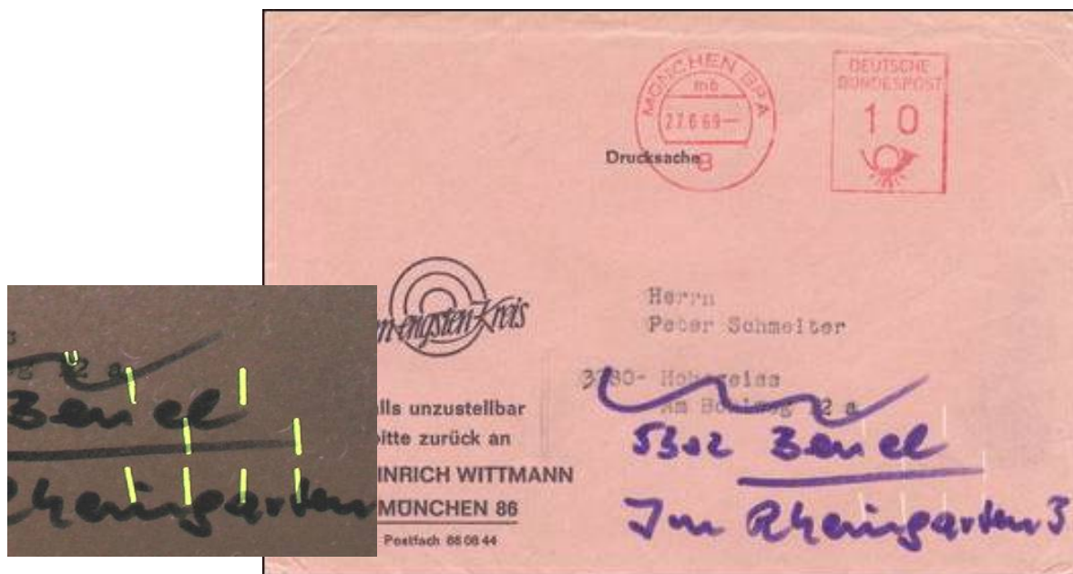
Bild 14 u. 15: Brief von München nach Hohegeiß über BS. Freistempler 27.6.69. Eingangscodierung mit Kurzcodetaste für Hohegeiß 9090 (fl.). PKZ U in Pos. II (fl.). Es ist deutlich zu erkennen, daß einige Führungen der Stempel bereits kurz nach Inbetriebnahme der neuen AEG- Druckwerke ausgeschlagen waren.
