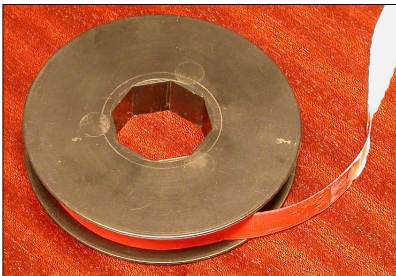
Bild 40: Eine neuwertige Farbbandspule Es wurden zunächst französische Bänder eingesetzt, später dann Bänder der deutschen Firma Pelikan.
