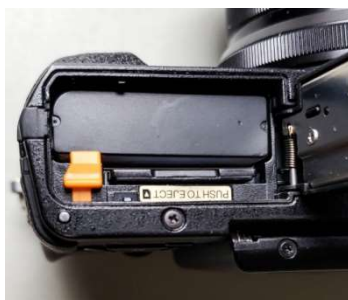
Bild 10-11: Akku-Einschub, rechts Akku und SD-Card im Schacht arretiert (siehe auch Bid 7- 8). Die gelbe Verriegelungstaste hält den Akku in Position.
