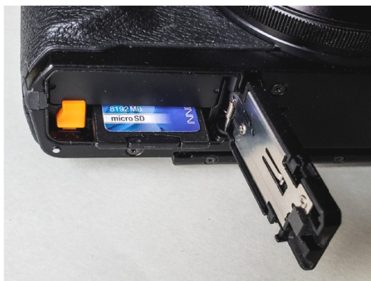
Bild 7- 8: Adapter Micro-SD Einschub neben Akku, rechts Adapter mit Micro-SD
