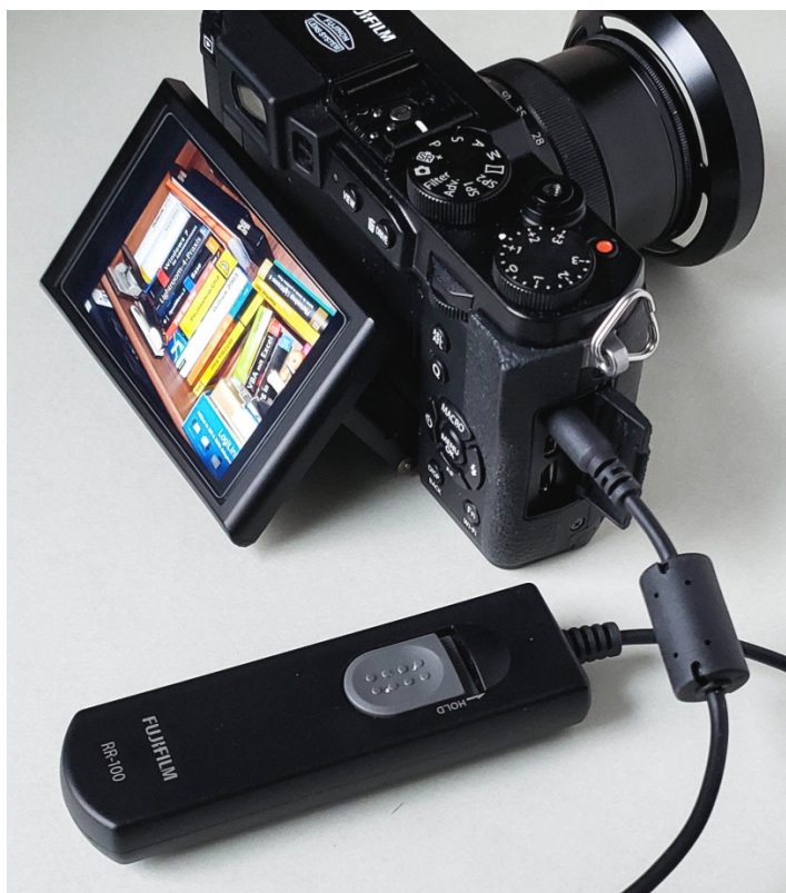
Bild 31- 32: Fernauslöser, rechts Fernauslöser RR-100 mit obere Ø 2,5 mm Klinkenbuchse verbunden
