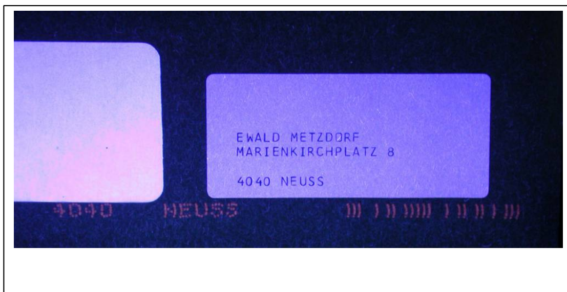
Testbrief unter UV. Vertikal 7 Pkt. auf 4,5 mm - Fluoreszenz orangerot.
