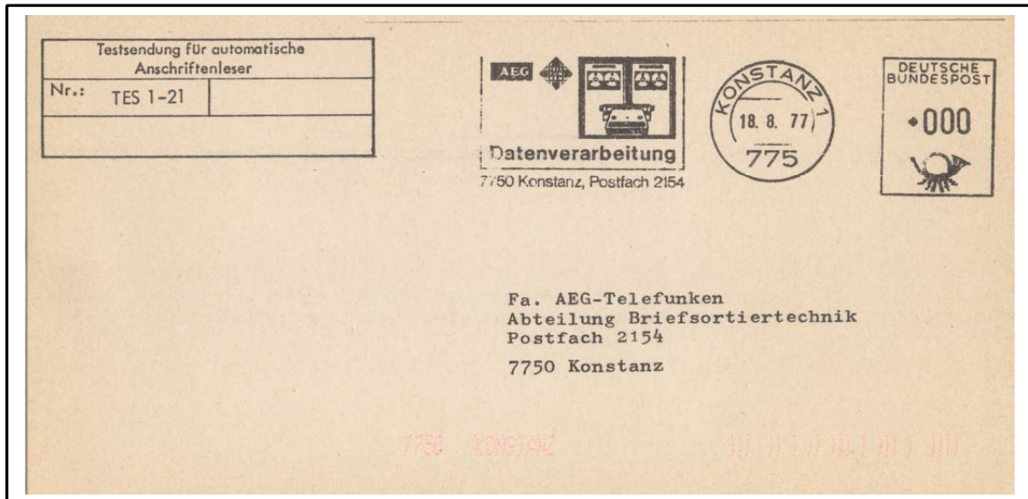
Testkarte (2150 x 105 mm) für den automatischen Anschriftenleser, Fabrikat AEG. Hier mit Klarschriftaufdruck: PLZ und Ort + Linearcode PLZ 7750. PZ=1+0=1 , T=7+0=7 , H=7+0=7 , Z=4+1=5 , E=4+7=11 \Rightarrow 0
