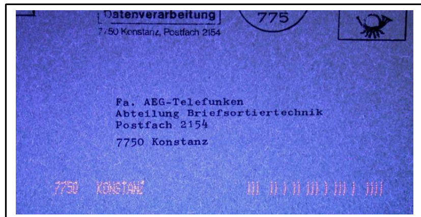
Testkarte unter UV. Vertikal 7 Pkt. auf 4,5 mm - Fluoreszenz orangefarben.
