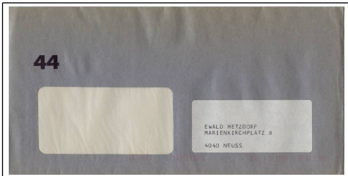
Testbrief (2200 x 112 mm) für den automatischen Anschriftenlesers, Fabrikat AEG. Hier mit Klarschriftaufdruck: PLZ und Ort + Linearcode PLZ 4040 – dicker Aufdruck. PZ=2+0=2 , T=4+0=4 , H=4+7=11 \Rightarrow 0 , Z=4+0=4 , E=4+7=11 \Rightarrow 0
