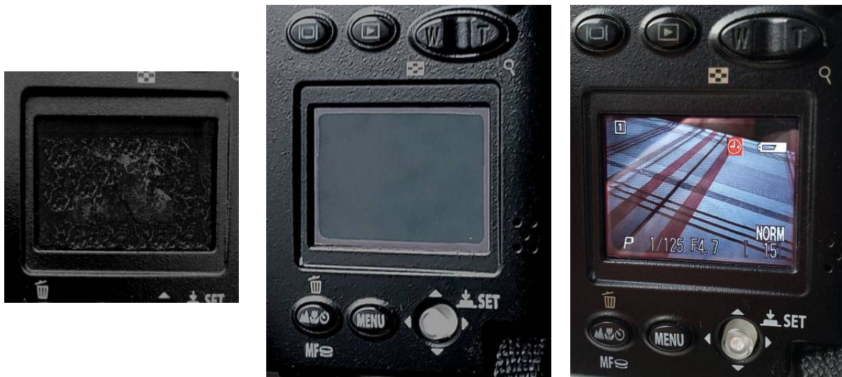
Bild 13abc : links der Abrieb der Antireflexbeschichtung im ausgeschalteten Zustand, mittig nach Behandlung mit Polierpaste und aufgelegter Schutzfolie im ausgeschalteten Zustand, rechts Kamera eingeschaltet.
