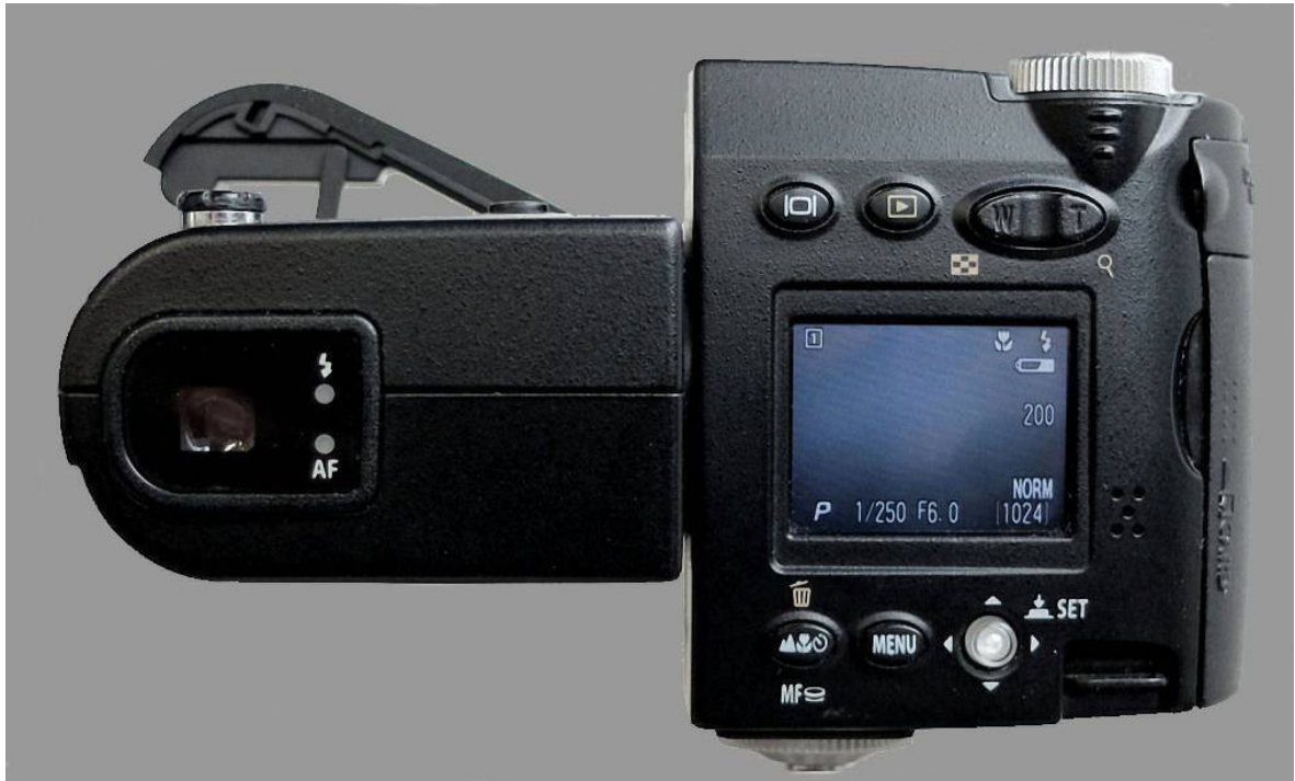
Bild 6: Rückansicht in Arbeitsstellung, links Objektiveinheit mit Fokuskontrolle (AF) und Blitzbereitschaft, rechts auf dem Monitor: oben links Benutzerkonfiguration, rechts Makro und Blitzbetrieb ein, darunter Akkuzustand und ISO 200, unten von links: Programmwahl, Belichtungszeit, Blende, Bildqualität mit Anzahl der noch möglichen [Aufnahmen] (abhängig von der Speicherkartengröße - hier z.B. 1024 Aufnahmen auf einer 1 GB maxflash)
