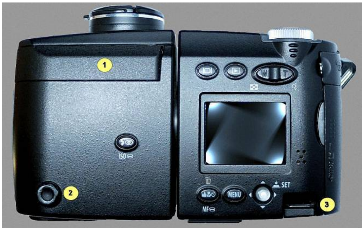
Bild 12: Kamera Rückseite, ① integriertes (geschlossenes) Blitzgerät, ② Blitzsynchronanschluß für externes Blitzgerät, ③ Öse für Tragriemen
