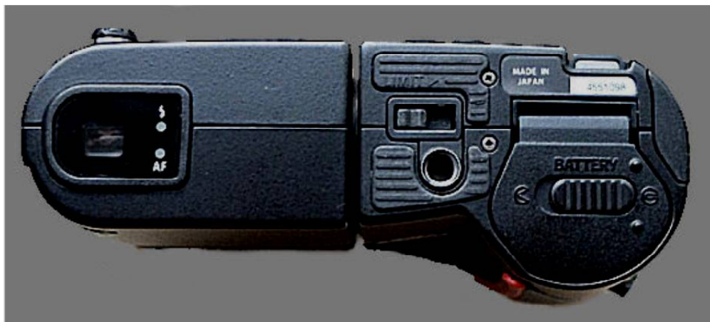
Bild 7: Ansicht Kameraboden in „Parkstellung“, links in der Objektiveinheit das Sucherokular, die AF- und Blitzkontrollleuchte, rechts der Verriegelungsschieber für das Drehgelenk, daneben das Stativgewinde und das Akkufach.
