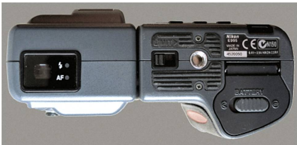
Bild 7: Ansicht Kameraboden in „Parkstellung“, links in der Objektiveinheit das Sucherokular, die AF- und Blitzkontrollleuchte, rechts der Verriegelungsschieber für das Drehgelenk, daneben das Stativgewinde und das Akkufach.
