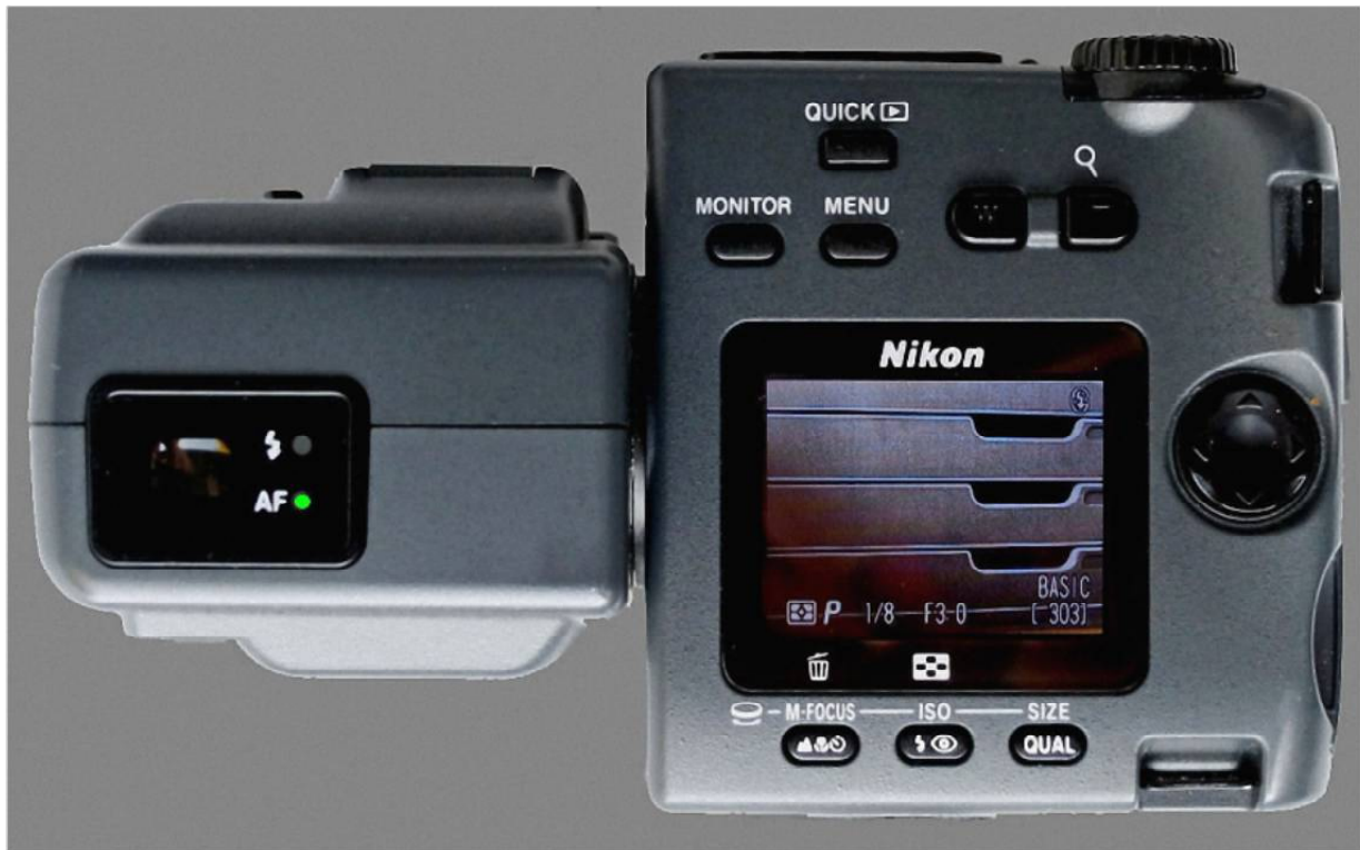
Bild 6: Rückansicht, Fokusanzeige (AF) links grün. Auf dem Monitor: oben Blitzunterdrückung, unten von links: Belichtungsmeßart, Programmwahl, Belichtungszeit, Blende, Bildqualität mit Anzahl der noch möglichen [Aufnahmen] (abhängig von der Speicherkartengröße - hier z.B. 303 Aufnahmen auf einer 128 MB ScanDisk - CompactFlash)
