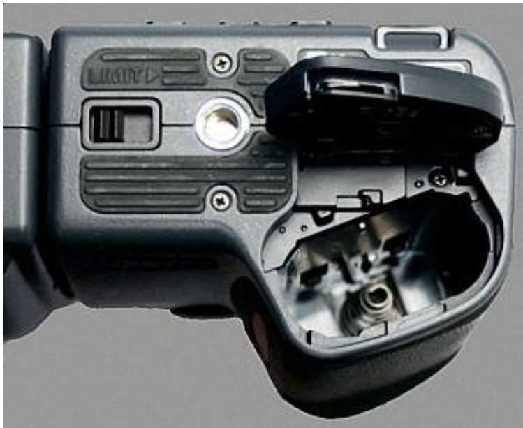
Bild 8 u. 8a: links geöffnetes Akkufach am Kameraboden, rechts der Nikon-Akku EN-EL 1
