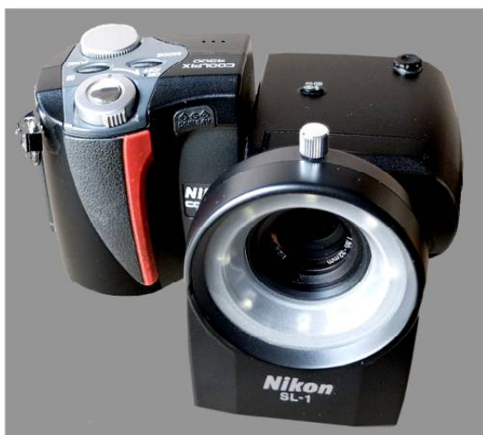
Bild 17: Die Nikon-Ringleuchte SL-1 am Objektiv befestigt.
