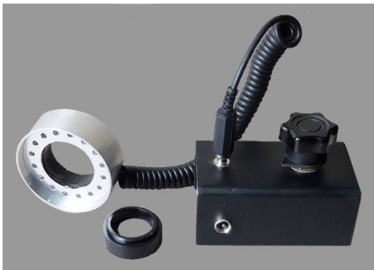
Bild 22 u. 22a : Die Ringleuchte mit Adapter und Potentiometer, rechts Netzteil
