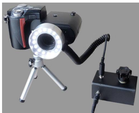
Bild 23 u. 23a: Die Kamera mit Adapter, Ringleuchte und Potentiometer, rechts Netzteil in Betrieb
