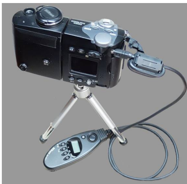
Bild 9 und 9a, 9b, 9c, 9d, 9e: Nikon Kabelfernauslöser MC-EU1 mit Batteriefach, MC-EU1 an Coolpix 4500
