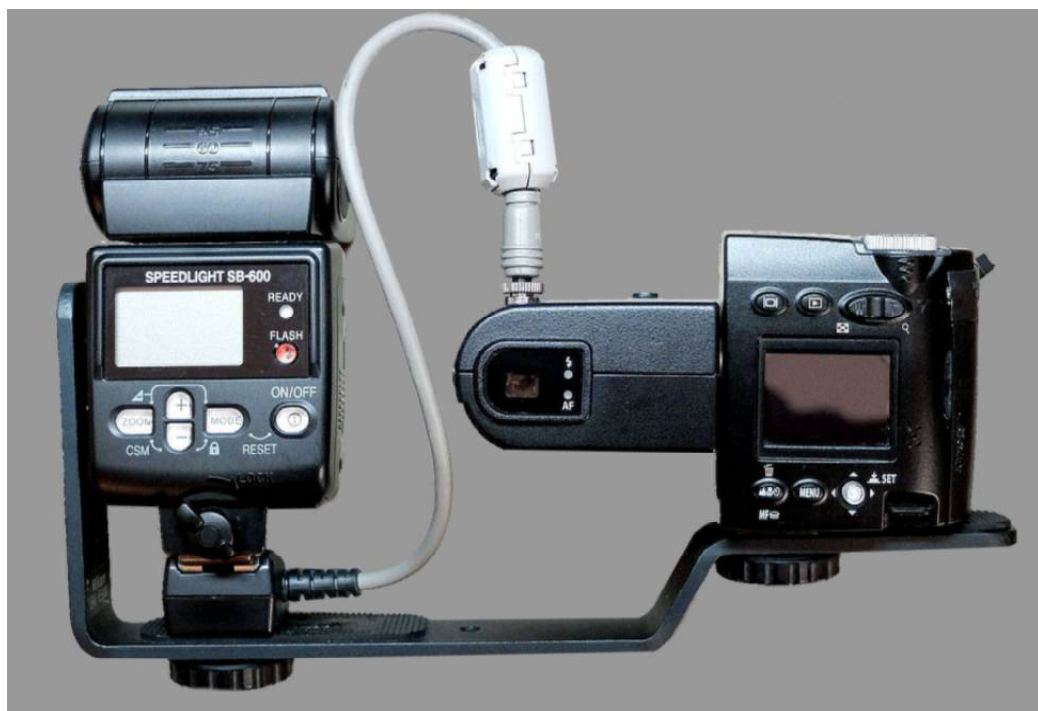
Bild 7 u. 7a: Multiblitzschiene mit Blitzgerät und Kamera
