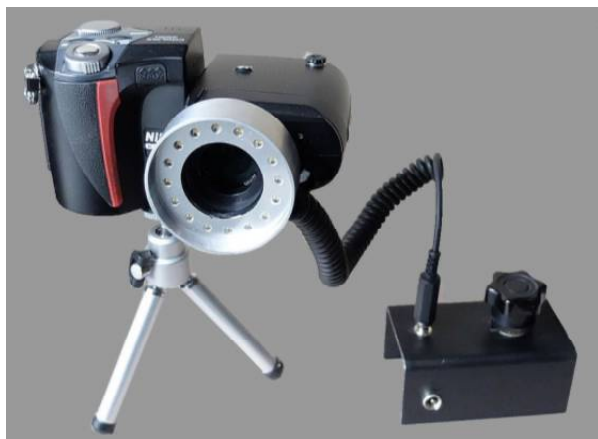
Bild 23 u. 23a: Die Kamera mit Adapter, Ringleuchte und Potentiometer, rechts Netzteil in Betrieb
