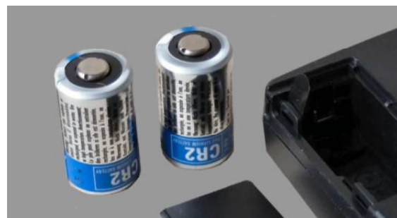
Bild 16 u. 16a, 16b, 16c: Ringleuchte SL-1 Rückseite, geöffnetes Batteriefach, zwei Batterien Lithium Typ CR2 (Fotobatterien)
