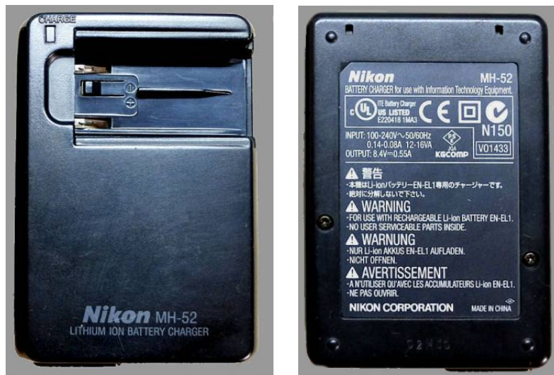
Bild 2 u. 2a: Akku-Ladegerät MH-52 für Lithium-Ionen-Akkus EN-EL 1
