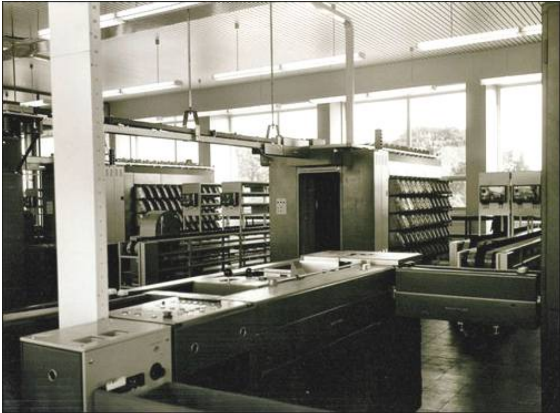
Bild 29: Aufbau Feinverteilmaschinen, Zwischenstapler, Stoffeingabe (Stadtarchiv Braunschweig H XXVIII: 87 Akz. 2008/135)
