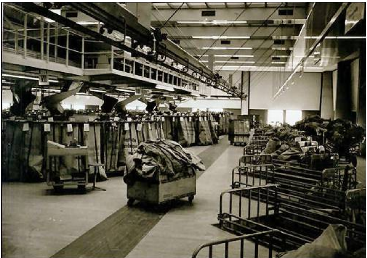
Bild 39: Päckchenförder- und verteilanlage
