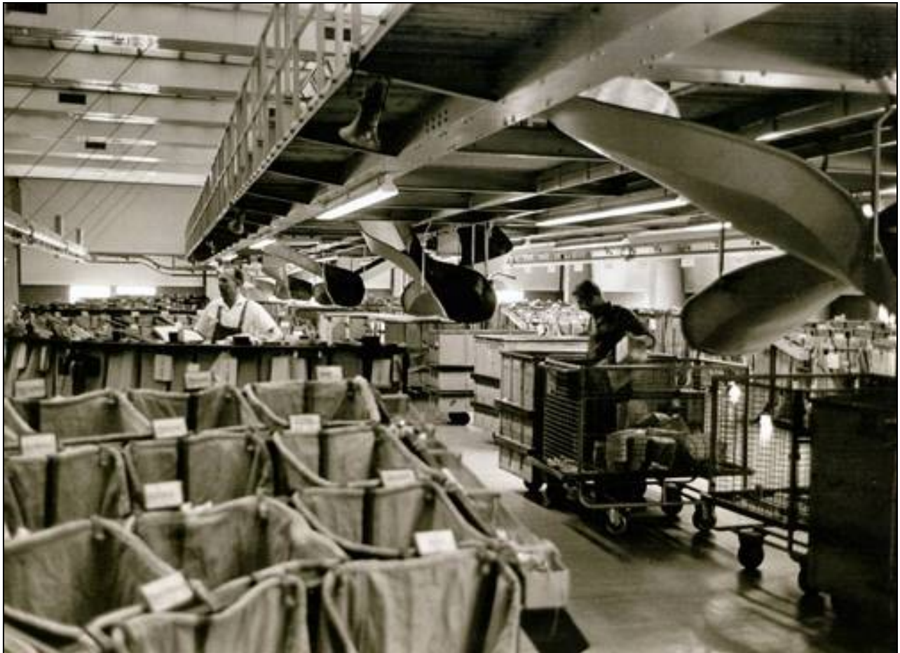
Bild 40: Päckchenförder- und Verteilanlage (Stadtarchiv Braunschweig H XXVIII: 87 Akz. 2008/135)
