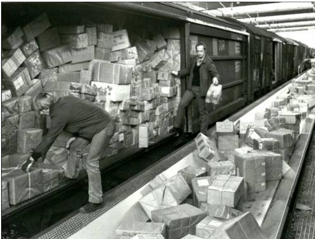
Bild 16: Bahnsteig Postbahnhof zwischen Gleis 306 u. 305 - Entladung mit Hilfe einer Förderstrecke, Blickrichtung in Richtung Einfahrt Postbahnhof (Stadtarchiv Braunschweig H XXVIII: 87 Akz. 2008/135)
