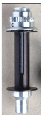
Bild 15a und 15b: Aufwickelspule Kleinbildfilm, und eingesetzte Aufwickelspule sowie der im Blendrahmen eingesetzte Filmgleitrahmen
