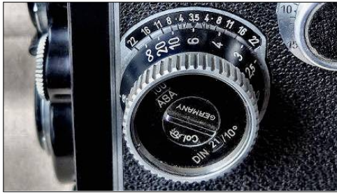
Bild 22: Triebknopf für Schärfentiefe
