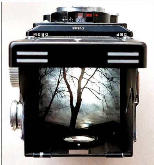
Bild 8: Blickfenster für Verschußzeit und Blende
