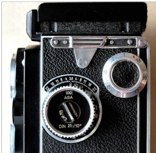
Bild 4 : links Stellrad Lichtwert und rechts Verriegelung und Freilauf
