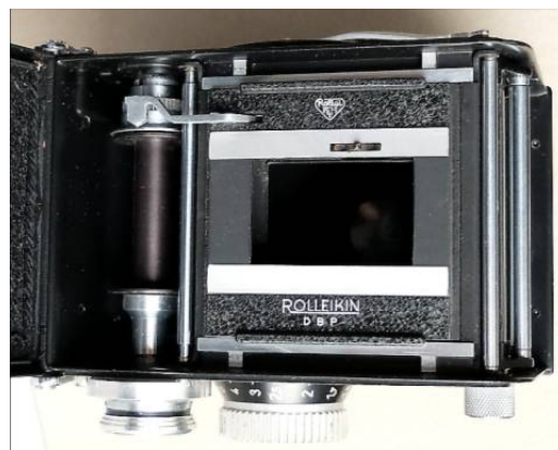
Bild 15a und 15b: Aufwickelspule Kleinbildfilm, und eingesetzte Aufwickelspule sowie der im Blendrahmen eingesetzte Filmgleitrahmen
