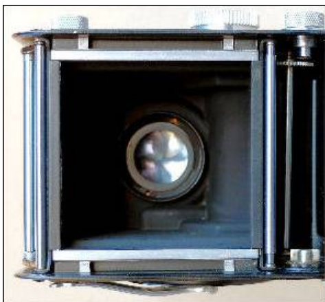
Bild 2d u. 2e : Automat K4A, links Aufnahmekammer mit Verschluss und rechts Sicht durch Lichtschacht auf Mattscheibe
