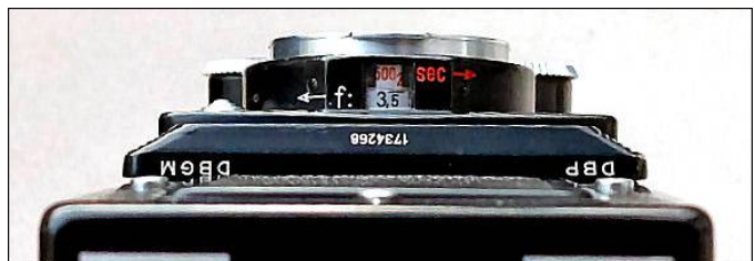
Bild 8: Blickfenster für Verschußzeit und Blende
