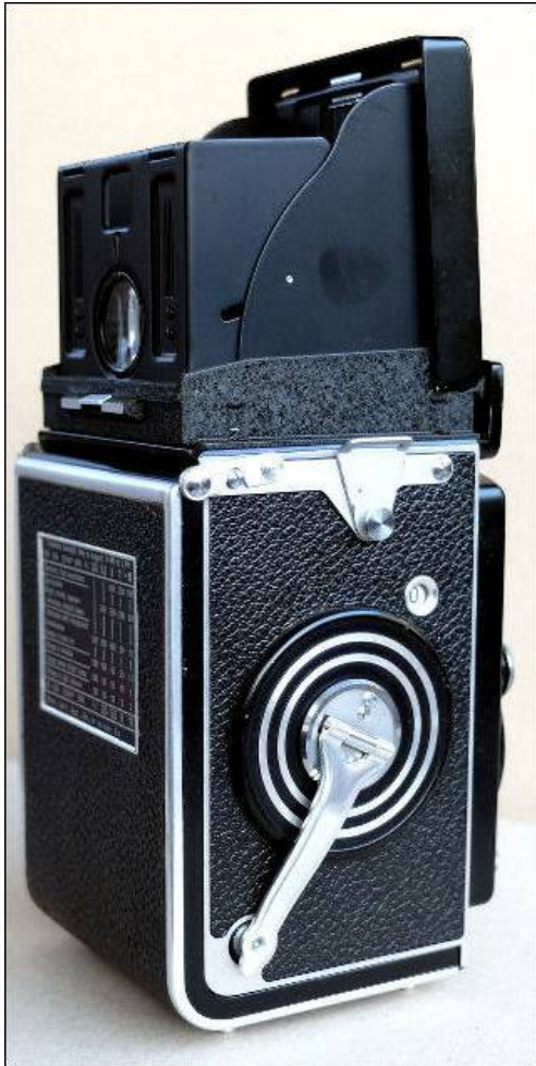
Bild 2b u. 2c : Automat K4A, links Kurbelseite mit Bildzähler und rechts Rückseite mit Belichtungstabelle
