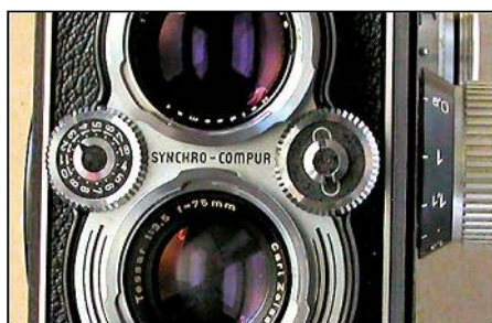
Bild 21: Verschuß- und Blenden-einstellung
