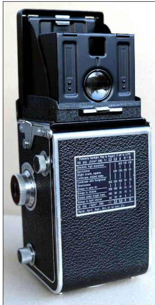
Bild 2b u. 2c : Automat K4A, links Kurbelseite mit Bildzähler und rechts Rückseite mit Belichtungstabelle
