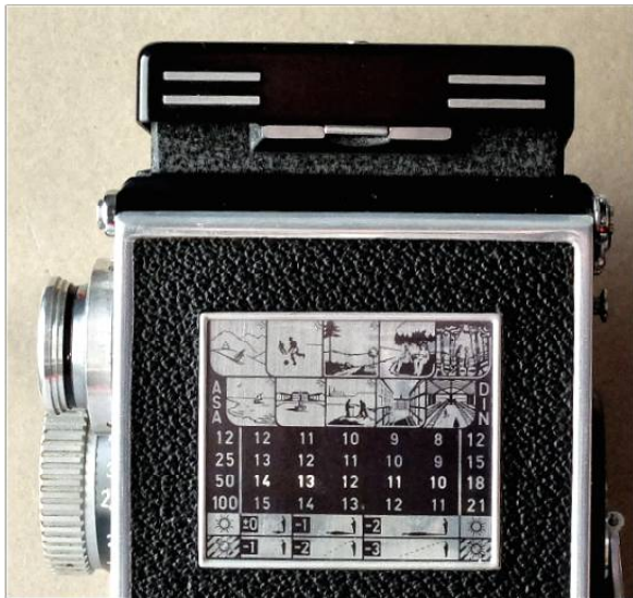
Bild 7: Belichtungstabelle an Zweiformat-Rückwand mit bildlicher Darstellung.
