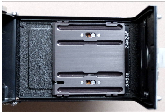
Bild 13a und 13b: Zweiformatrückwand mit einstellbarer Film-Andruckplatte
