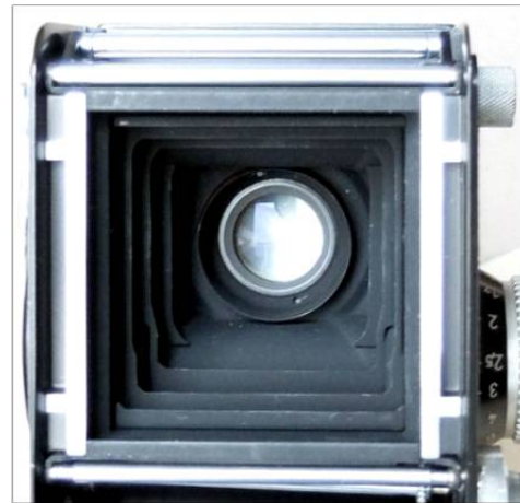
Bild 12: Aufnahmekammer mit Blendrahmen der Rolleiflex 3,5 B
