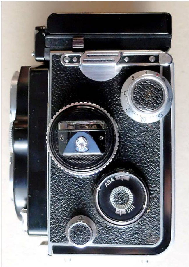
Bild 7 und 8: Oben rechts Großer Zählknopf (Rolleikin), links großer Entfernungsknopf mit integriertem Belichtungsmesser, darunter Knopf mit Filmeinstellscheibe sowie für die Filterkorrektur-einstellung, unten Rückspulknopf
