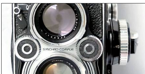
Bild 10: Mitte linkes Stellrad für Zeiten, rechtes für die Blendenvahl (unverriegelt). Oben links: Hebel V zur Anwahl X-Kontakt für Elektronenblitz oder M-Kontakt für Blitzlampen.
