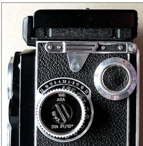
Bild 3: Entfernungsknopf und großer Zählknopf
