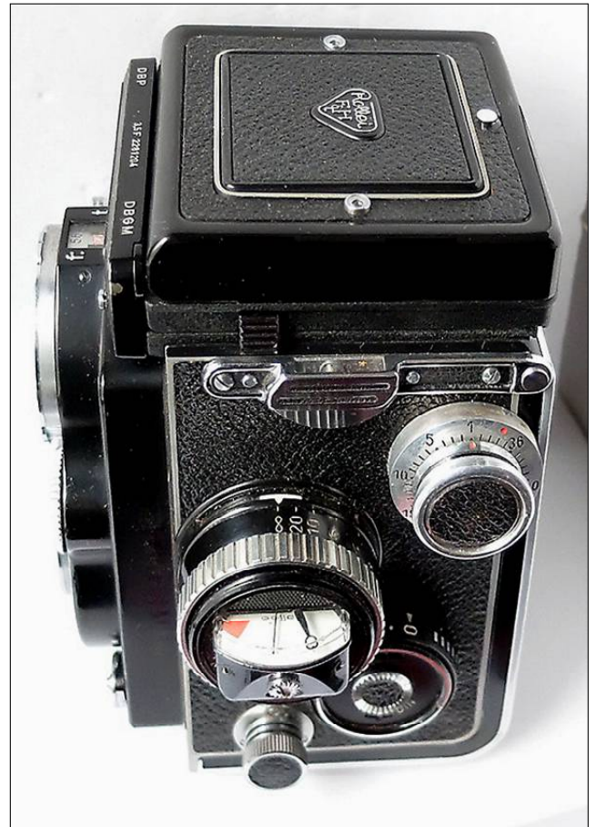
Bild 7 und 8: Oben rechts Großer Zählknopf (Rolleikin), links großer Entfernungsknopf mit integriertem Belichtungsmesser, darunter Knopf mit Filmeinstellscheibe sowie für die Filterkorrektur-einstellung, unten Rückspulknopf
