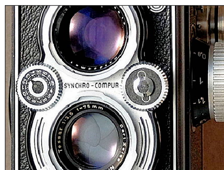
Bild 2 : links Stellrad Lichtwert und rechts Verriegelung und Freilauf
