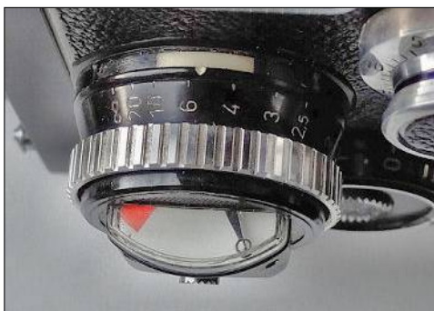
Bild 18: Triebknopf für Schärfentiefe
