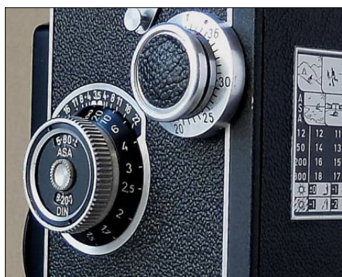
Bild 3: Entfernungsknopf mit Schärfentiefenskala, rechts großer Zählknopf Rolleikin
