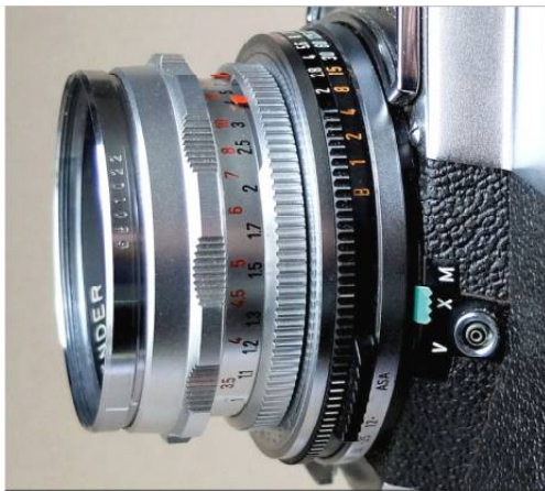
Bild 26 u. 27: Compur-Verschluss mit Septon 1:2/50 mm, Einstellung: links manuelle Belichtung, rechts für Automatikbetrieb
