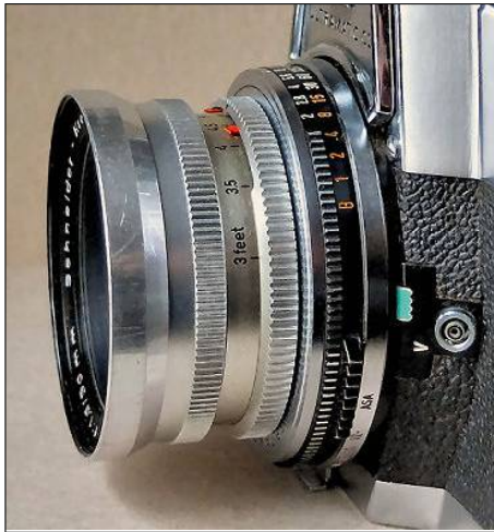
Bild 11 und 12: Synchro-Compur-Verschluss mit Fremdobjektiv
