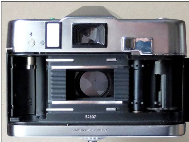
Bild 24 u. 25: Kamera-Rückwand geöffnet, Verschluss: links ausgelöst, rechts gespannt.
