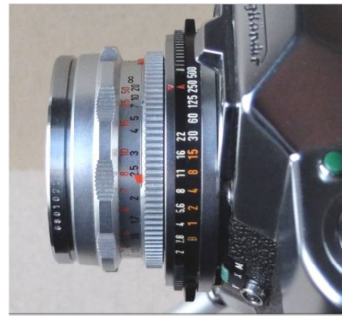
Bild 26 u. 27: Compur-Verschluss mit Septon 1:2/50 mm, Einstellung: links manuelle Belichtung, rechts für Automatikbetrieb
