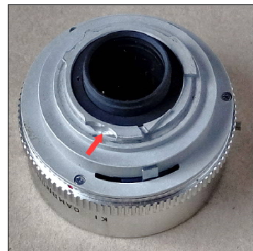
Bild 52, 53, 54: KI RETINA CAMBRON 2x AUTOTELE CONVERTER mit Manipulation DKL-Bajonett
